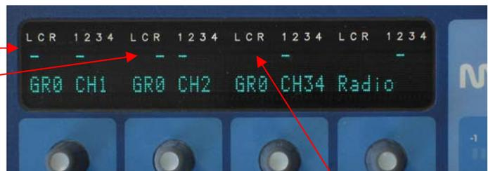
GR0 CH34 sind im Stereo-Modus auf den Kanalstreifen **C** geschaltet - **kein Unterstrich** . ●
