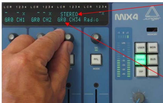
• Dabei sieht man im Display in der oberen Zeile, wie die Signale dieser Quelle behandelt werden. Durch Drücken auf den Kanaldrehknopf wird der Modus zwischen:
