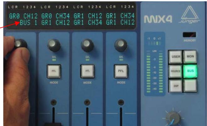
Auf der Eingangsseite kann man unabhängig von diesen Einstellung die gewünschten Kanäle des SDI-Signals auf die Kanalstreifen des MIX4 legen :
