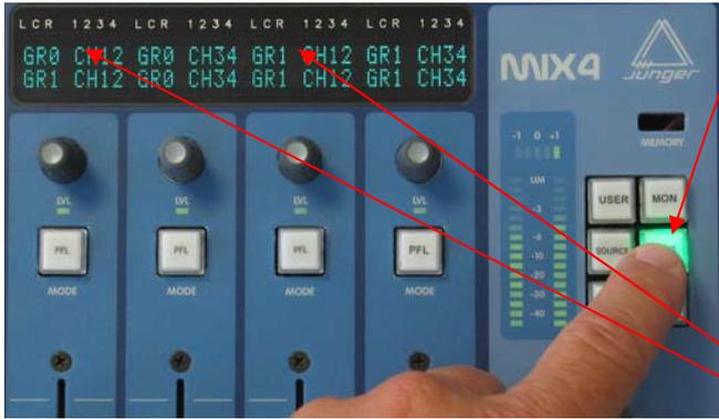
• Wenn man die **<BUS>** Taste drückt, dann sieht man im Display des MIX4 das Menü, um die Zuordnung der Kanäle für den Embedder einzustellen.
