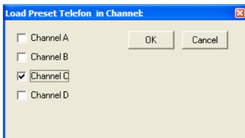
Hier kann man einen oder mehrere Kanalstreifen auswählen, in den (die) der Preset geladen werden soll(en)
