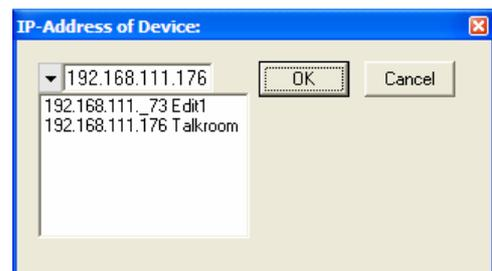
Die Verbindungsdaten werden in der Registry des Betriebssystems gespeichert. Wenn Sie viele Verbindungen haben und die Einstellungen auf einen anderen PC mitnehmen möchten, dann exportieren Sie bitte den Registry-Schlüssel: **HKEY\_LOCAL\_MACHINE\SOFTWARE\Juenger Audio\SDM4 Backup\**
